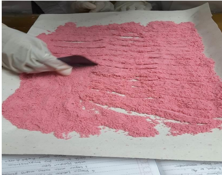
Gambar 10. Cacah dengan sudip untuk memberi udara bagi bawah granul agar panas dapat masuk
