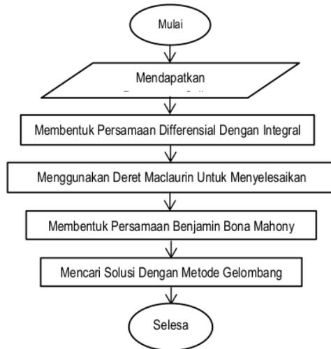
**Gambar 1.** Diagram Alir Metode metode BBM pada pengukuran tinggi gelombang di Selat Madura
